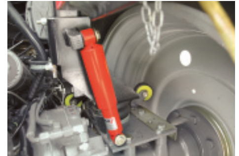
▲ Zweistufige pneumatische Kabinenfederung in Serie.
