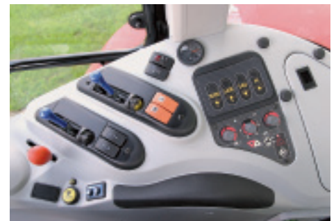
Hydraulik- und Zapfwellenbedienung auf der rechten Bedienkonsole.
