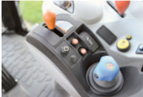
Übersichtliche Armlehnenbedienung mit dem Getriebe-Fahrhebel.
