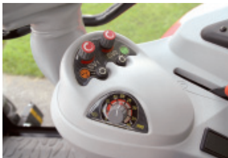
Potentiometer für die Einstellung der Tempomatgeschwindigkeiten bzw. der Grenzlastregelung.
