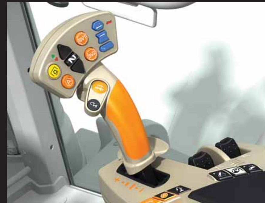
Moderner MultiPad-Hebel auf der linken Seite der Steuer- und Bedienarmlehne und entweder Tippschalter oder Multifunktions-Joystick zur Bedienung der Steuerventile auf der rechten Seite der Armlehne
